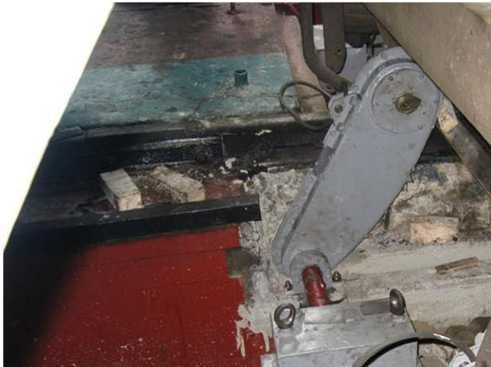
Ориентировочно: усилие армированного резинового ролика на колесо 40 тн., резца 2 тн.
